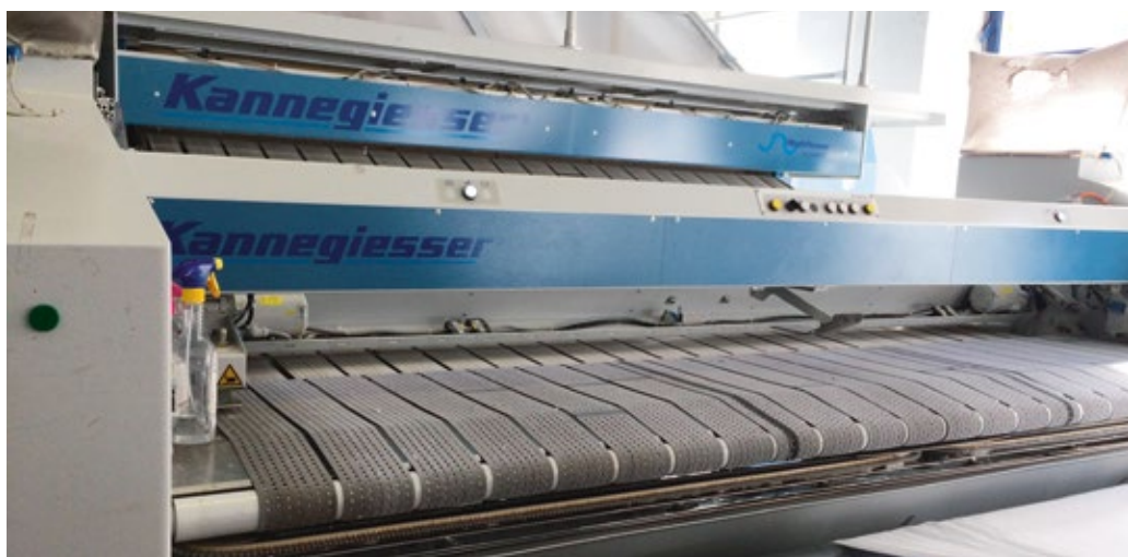
Bügelmaschine für Flachwäsche in der Wäscherei Furigan
